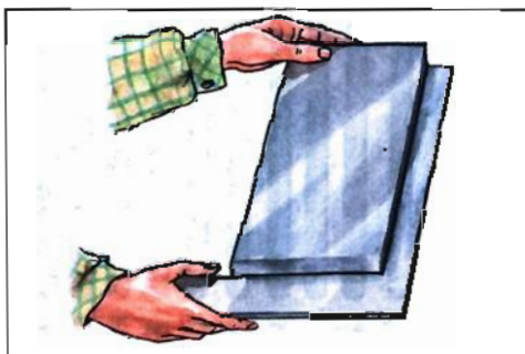
Рис. 137. Контроль опиленных поверхностей угольником
